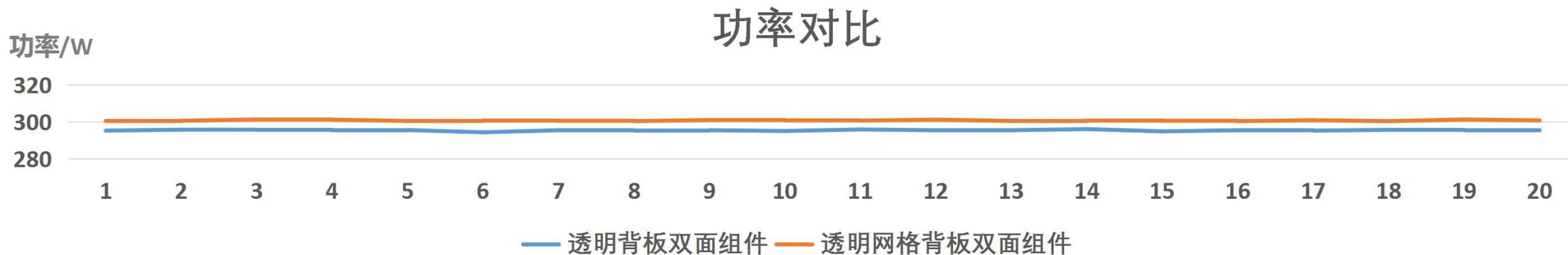
经过层压后的两种版型组件功率统计对比来看，透明网格背板能有效增加组件功率达5W以上。
